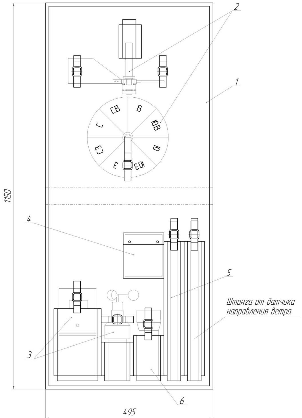
1 – чехол; 2 – датчик направления ветра; 3 – анемометр ручной электронный АРЭ; 4 – компас горно-геологический ГГК; 5 – термометр метеорологический прашевой ТМ-8; 6 - фонарь.
